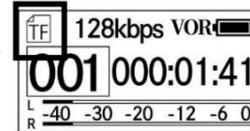
※microSD カードが挿入されていない、もしくは正しく挿入されていない場合、録音場所の「カード」は選択できません。
