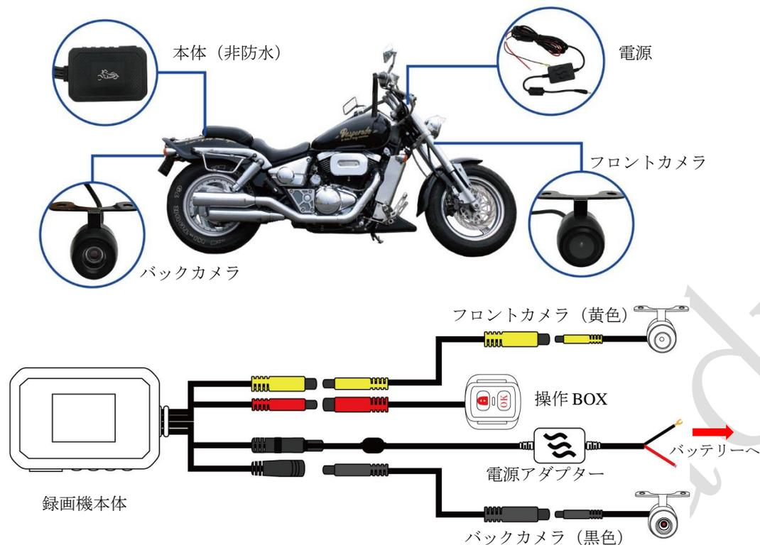
・カメラコネクタ接続の際は、コネクタの中の突起部分を確認して同じ位置になるように挿入ください。
