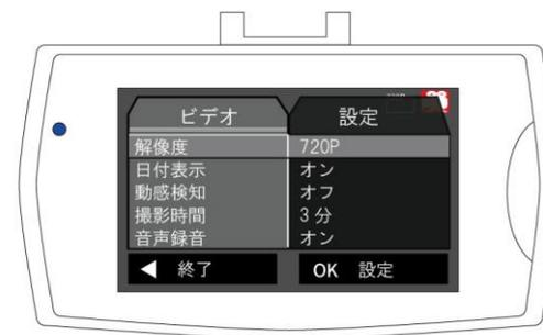
(2) 設定メニューでは“方向ボタン”により項目選択後、“OKボタン”で項目確定します。
