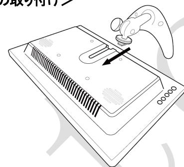
モニター背面のスリットにスライドさせてはめて、お好みの位置で手回しネジを回して固定します。
