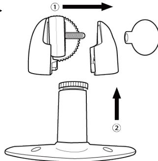
下図のようにネジを緩めてばらし、台座をはめて再びネジをしめます。
