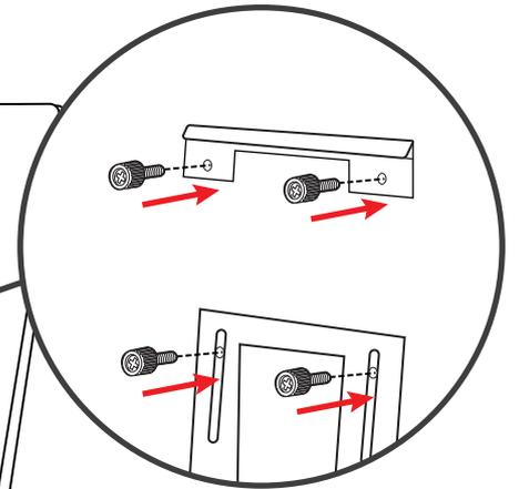
LCD背部にLCD背面座を付属のビスで固定してください
