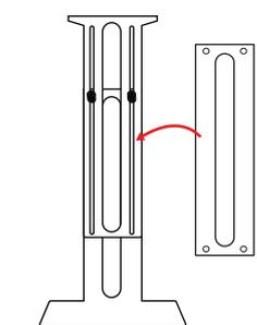
ビスを外して延長支柱を上支柱と下支柱の間に入れます
