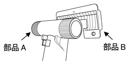
③モニターの背面に③を取り付け、ネジ穴 2カ所に付属のネジを挿入してドライバーで固定します。
