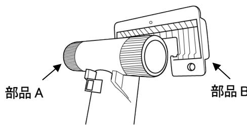
④モニターの背面に③を取り付け、ネジ穴 2カ所に付属のネジを挿入してドライバーで固定します。
