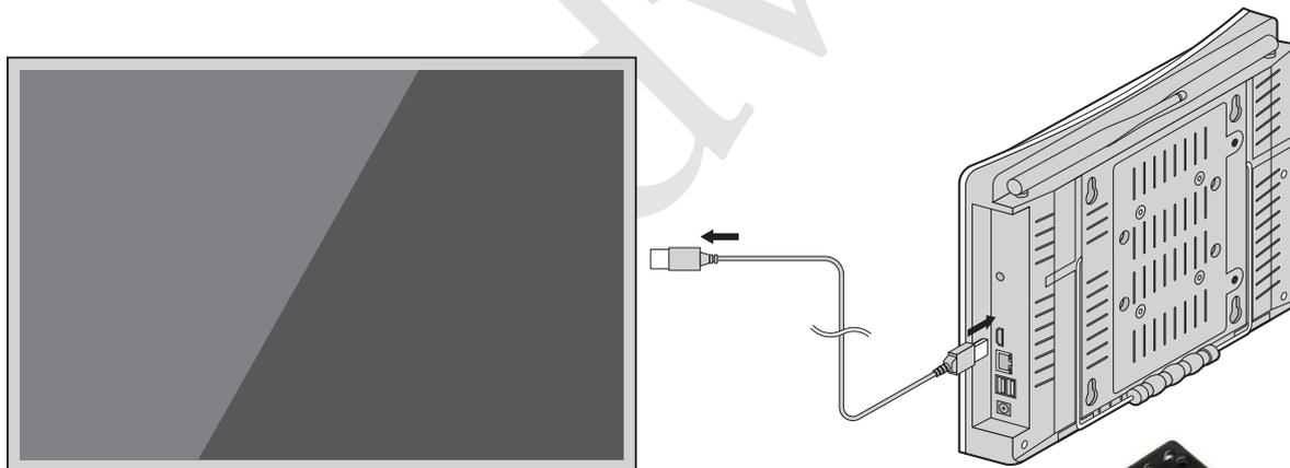
※録画機・外部モニター両方に同じ内容が表示されます。録画機側の表示を消すには、録画機画面右下の「SCREEN」ボタンを押してください。(もう一度押すと再表示されます。)
