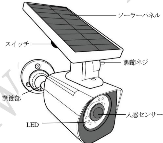
ソーラーパネルに太陽光が良く当たるような方向に調節して設置ください。
