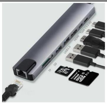
USB Type-C オス対応(Thunderbolt3 コンパチ) RJ-45(100/10M), SD/Micro SD スロット USB3.0\*2ポート MAX 4.5W、HDMI(4K 対応) Type-C メス 1ポート (PD 対応 MAX87W) Type-C メス 1ポート (MAX.4.5W)、
